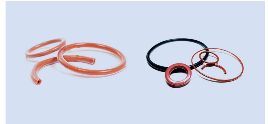
Die Ummantelung lässt keinerlei Permeation zu und sorgt so für die chemische Beständigkeit. Der Elastomerkern schafft die gleichmäßige Anpressung des Rings auf die Dichtstelle. Eine ummantelte Dichtung ist allerdings im Vergleich zu einem reinen Elastomer weniger elastisch. Für den Einbau ummantelter O-Ringe muss berücksichtigt werden, dass er nur begrenzt dehn- und stauchbar ist.
